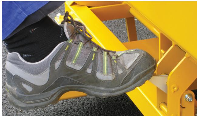
Nous proposons le VSA. Se déverrouille par appui du pied et se verrouille automatiquement.
